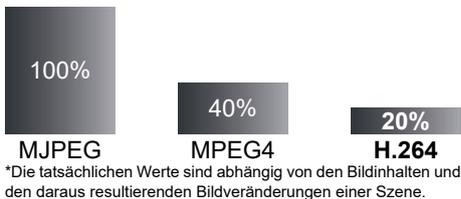
Komprimierungsverfahren verringern den Datenverkehr auf dem Netzwerk und erhöhen gleichzeitig die Aufzeichnungsdauer.
